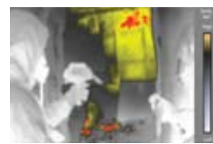
détection de chaleur en rouge clair avec points chauds en noir
