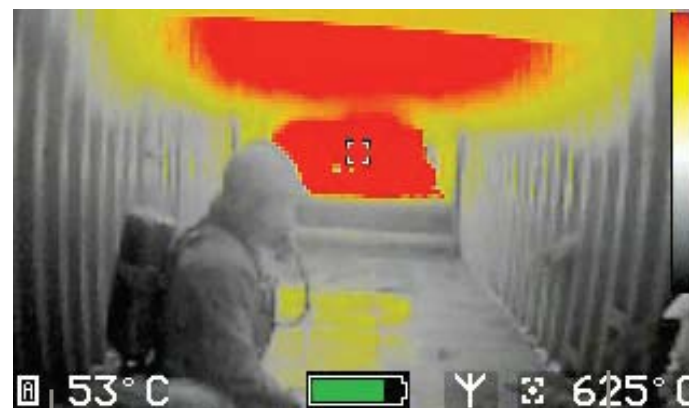
Misurazione diretta della temperatura di una zona specifica Misurazione della temperatura ambiente
